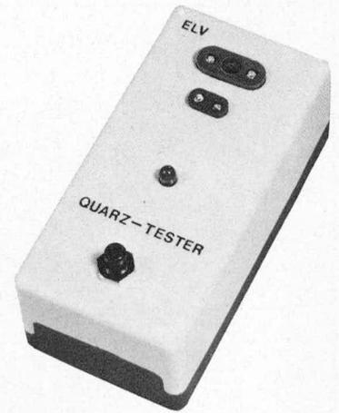
**Zur Überprüfung von Quarzen aller gebräuchlichen Frequenzbereiche, dient diese kleine Testschaltung. Wer häufiger mit Oszillatoren und Quarzen zu tun hat, wird in dieser Schaltung ein wertvolles Hilfsmittel finden.**
