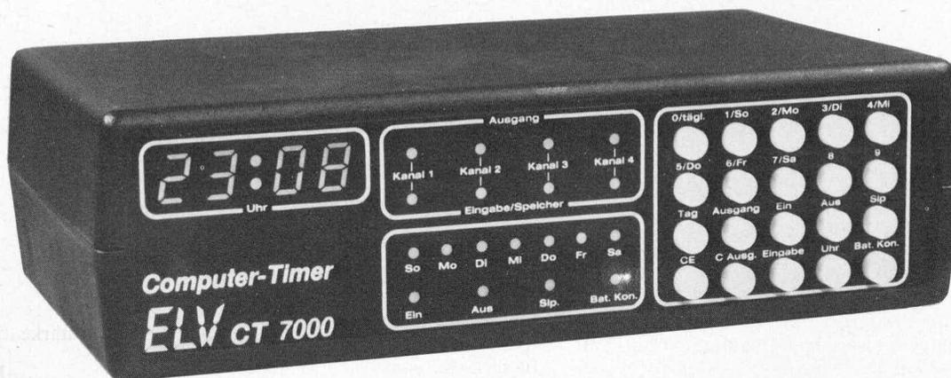
*Der ELV Computer-Timer CT 7000 ist eine digitale, elektronische 24-Stunden-Zeitschaltuhr mit vier, voneinander völlig unabhängigen Schaltausgängen, die auf einfache Weise mit max. 20 Ein- und Auschaltzeiten programmiert werden kann, wobei die Zeiten bis zu einer Woche im voraus und dann mit wöchentlicher Wiederholung eingegeben werden können.*
