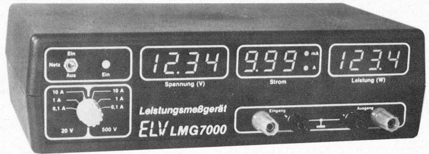
*In diesem zweiten und abschließenden Teil stellen wir Ihnen die komplette Schaltung sowie das Platinenlayout des ELV-Leistungsmessgerätes LMG 7000 vor. Besonders hervorzuheben ist die große Frequenzbandbreite bei Wechselspannungs- und -strommessungen bei voller Genauigkeit.*
