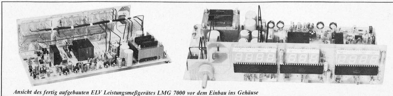
Ansicht des fertig aufgebauten ELV Leistungsmeßgerätes LMG 7000 vor dem Einbau ins Gehäuse
