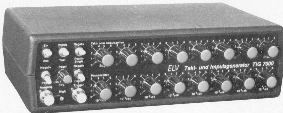
Als weiteres Gerät in der ELV-Serie 7000 stellen wir Ihnen einen Takt- und Impulsgenerator vor, der einen Frequenzbereich von 0,0005 Hz bis 5 MHz überstreicht und eine Impulszeit von  $1 \times 10^{-7}$  sec. bis  $1 \times 10^3$  sec. aufweist.
