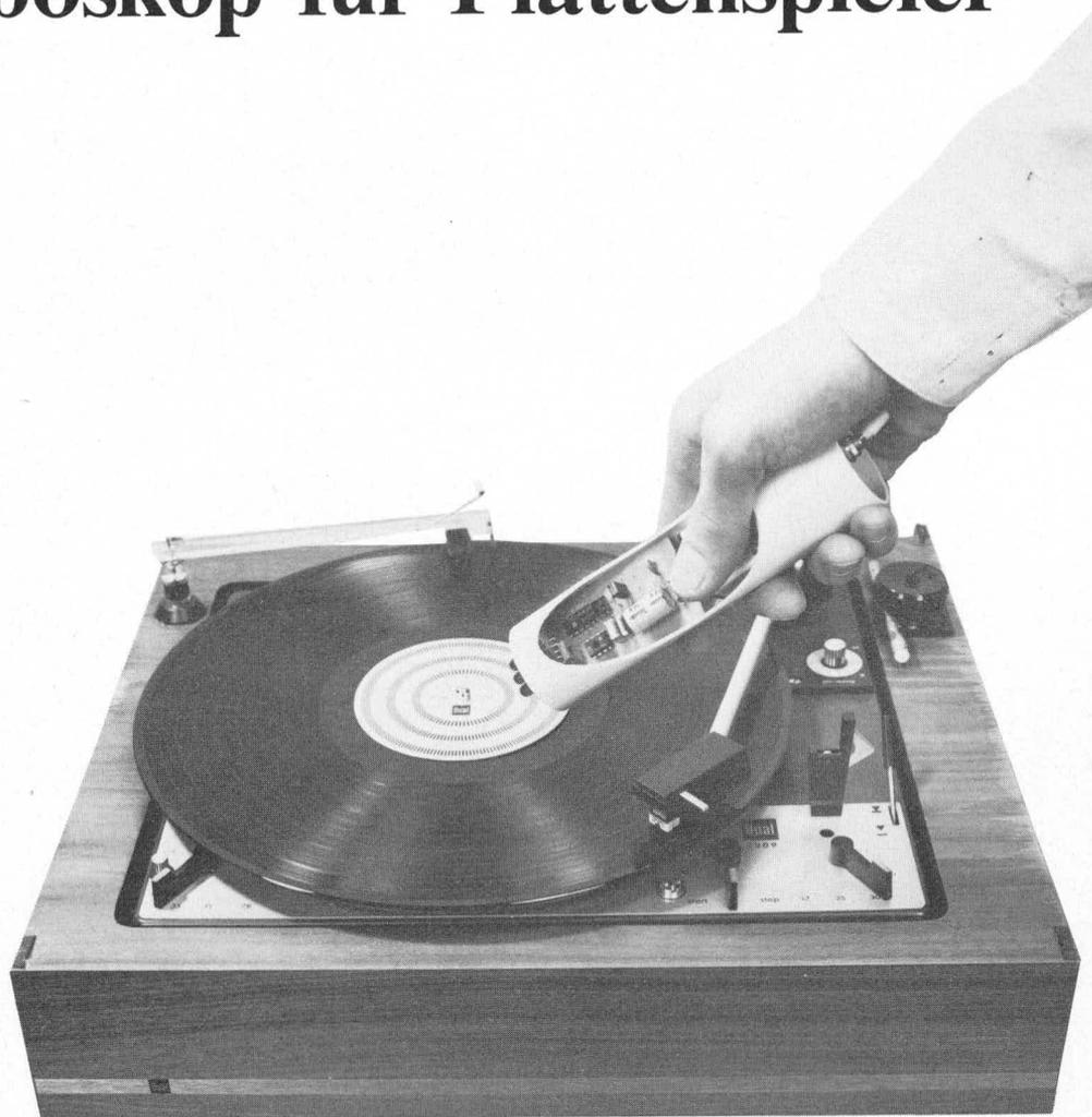
*Mit der hier vorgestellten leicht nachzubauenden Schaltung kann die Drehzahl eines Plattenspielers quazgenau überprüft und eingestellt werden. Ein besonderer Vorteil dieser im ELV-Labor entwickelten Schaltung liegt in dem Tastverhältnis von ca. 3 : 1, wodurch sich eine besonders „scharfe Abbildung“ auf der Stroboskopscheibe ergibt.*
