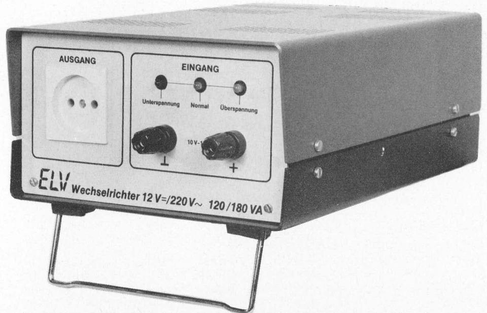
*Mit der hier vorgestellten Wechselrichterschaltung läßt sich eine 12 V Gleichspannung in eine 220 V Wechselspannung umformen, wobei die Besonderheit darin liegt, daß die Ausgangsspannung sowohl frequenzstabilisiert (Quarzeitbasis) als auch spannungsstabilisiert ist. In Zusammenhang mit vorgenannten Eigenschaften und einer Spitzenleistung von über 180 VA stehen dem Gerät universelle Einsatzmöglichkeiten offen.*
