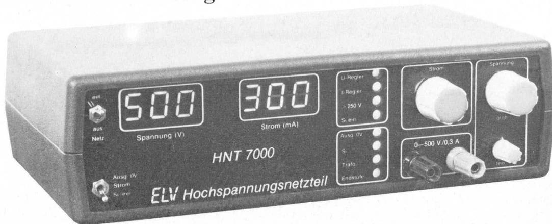
*Als vierzehntes Gerät in der ELV-Serie 7000 stellen wir Ihnen ein Hochspannungs-Netzteil vor, das eine ähnlich komfortable Steuerelektronik besitzt, wie das inzwischen weit verbreitete ELV-Super-Netzgerät SNT 7000.*
