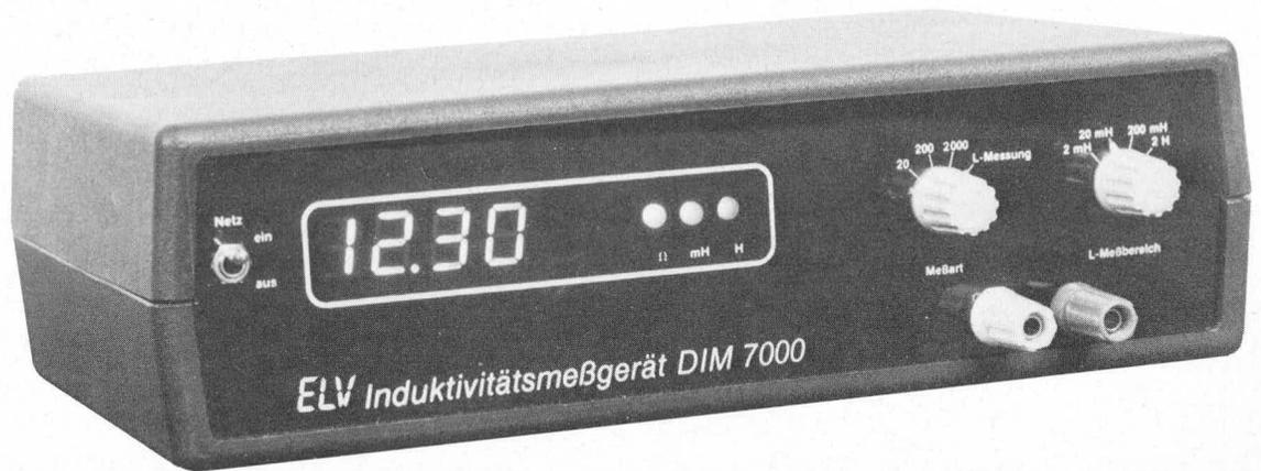
*Mit dem hier vorgestellten, im ELV-Labor entwickelten, Digitalen Induktivitätsmeßgerät können in 4 Meßbereichen Induktivitäten von wenigen  $\mu\text{H}$  bis hin zu  $2\text{H}$  gemessen werden und das bei einer Auflösung von  $1\mu\text{H}$  im kleinsten Bereich.*
