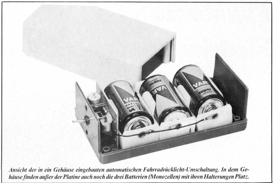
Ansicht der in ein Gehäuse eingebauten automatischen Fahrradrücklicht-Umschaltung. In dem Gehäuse finden außer der Platine auch noch die drei Batterien (Monozellen) mit ihren Halterungen Platz.
