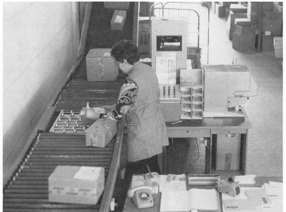
Im Laufband integrierter automatischer Wiege- und Portocomputer
