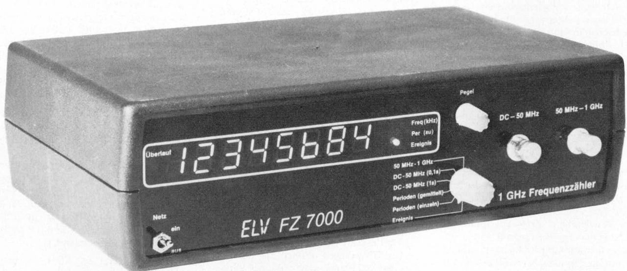
Ansicht des fertigen 1-GHz-Frequenzzählers FZ 7000
