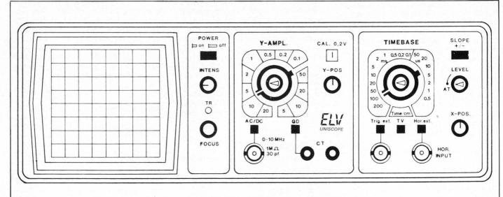
Frontplatte des 10 MHz-Oszilloskopes (ELV-UNISCOPE)
