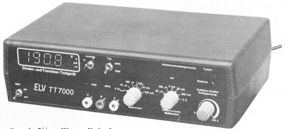
*Mit diesem Dioden- und Transistortestgerät mit 3½-stelliger digitaler Anzeige können sämtliche bipolaren NPN – oder PNP – Transistoren sowie Dioden auf ihre Funktion hin überprüft werden.*
