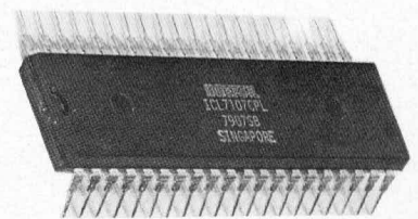
So müssen die Beinchen des IC 2 vor dem Einbau gebogen werden
