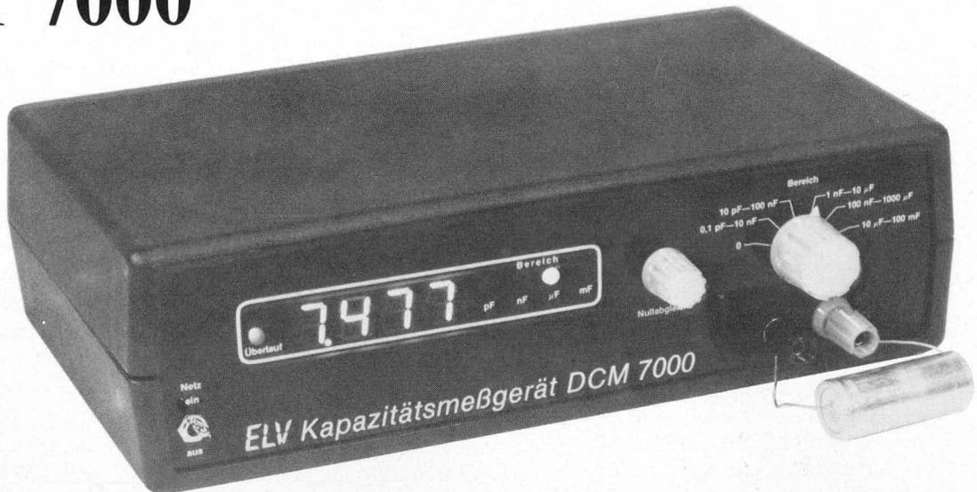
*Auf das hier vorgestellte, in unserem Labor entwickelte Digitale Kapazitätsmeßgerät dürfen wir wohl zu Recht stolz sein, denn es handelt sich um ein echtes Spitzengerät, mit einem Meßumfang von 0,1 pF (!) bis 100 000  $\mu$ F (!) sowie einem Nullabgleich, um Streu- bzw. Kabelkapazitäten zu kompensieren.*
