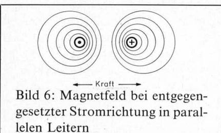
Es ist deutlich zu sehen, daß zwischen den Leitern eine Feldverdichtung eintritt. Hierdurch entsteht eine Kraft, die die Kabel auseinander drückt. Unter normalen Bedingungen sind die Kräfte sehr klein. Sobald aber sehr große Ströme fließen können, wie z. B. in Strommaschinen von Starkstromversorgungsanlagen, müssen besondere Vorkehrungen für die Befestigung der durchströmten Leiter getroffen werden.
