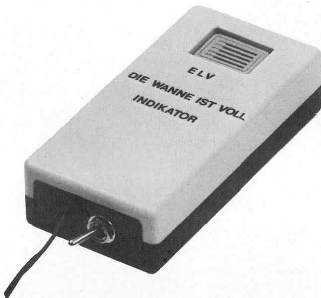
*Mit dem hier vorgestellten, handlichen und problemlos aufzubauenden Gerät kann der Füllstand (z. B. der Badewanne) über einen Signalton angezeigt werden.*
