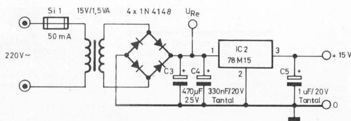
Bild 1 Schaltbild der Steuerschaltung
