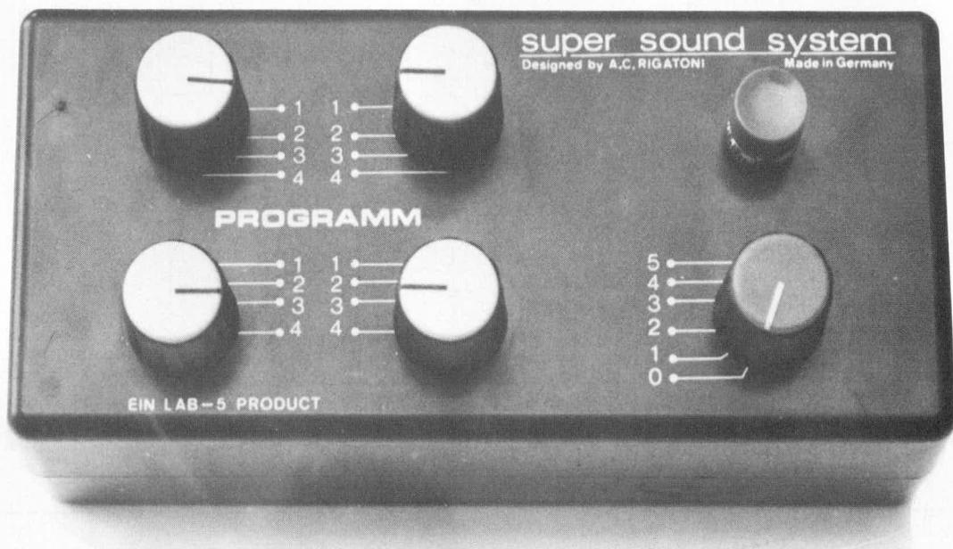
*Mit dieser Sirene können verschiedene Sirengeräusche erzeugt werden. Die Programmierung erfolgt über vier Stufenschalter und ist somit sehr leicht zu verändern. Die Schaltung ermöglicht u.a. die Simulation des bundesdeutschen Martinshorns, der Kojak-Sirene und der Hawaii 5-0-Sirene. Insgesamt sind 256 verschiedene Geräusche möglich.*
