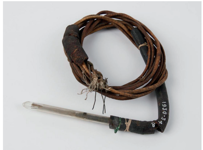
▲ Bild 3: Rectum-Platin-Thermometer by Callendar (Quelle).
