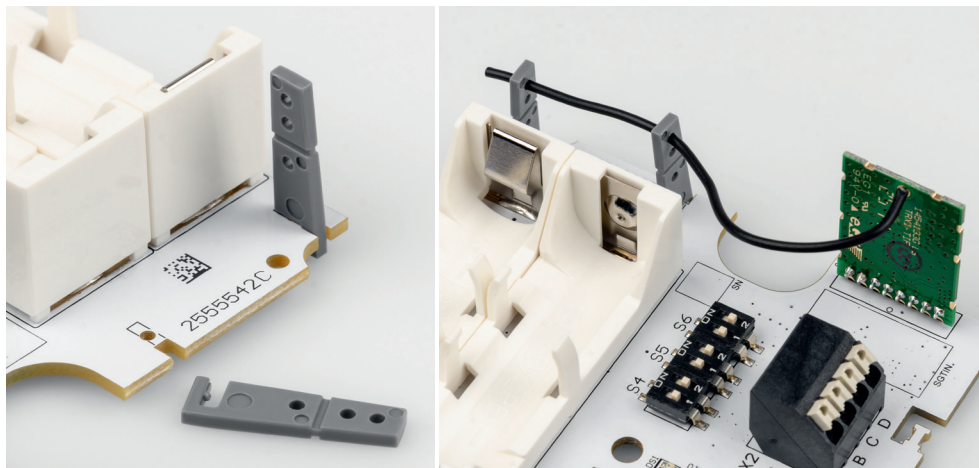
▲ Bild 10: Antennenhalter einsetzen und Antenne verlegen
