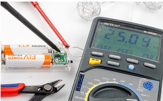
▲ Bild 11: Stromaufnahme messen (aufgetrennt und mit Multimeter)
