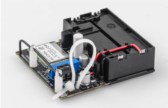
▲ Bild 16: Kabelbinder in die Platine einführen
