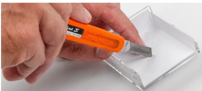
▲ Bild 15: Öffnung für Bedientaste freilegen
