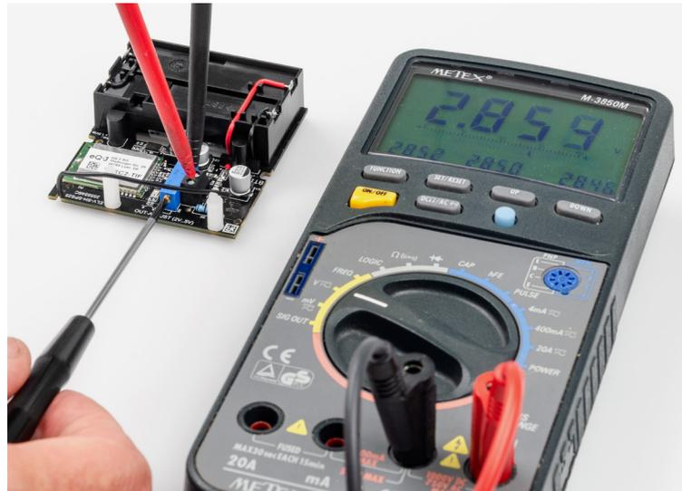
▲ Bild 12: Einstellen der Ausgangsspannung
