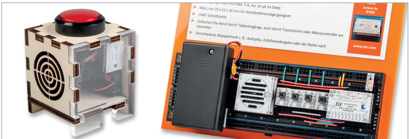
Bild 3: Demoaufbau mit Soundwürfel und mit einem Steckboard
