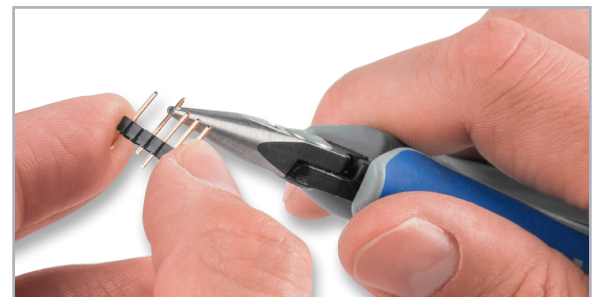
Bild 9: So kann man einzelne Stifte aus einer Stiftleiste herausziehen.
