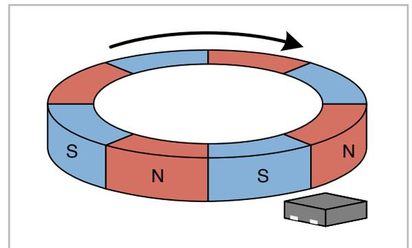
Bild 10: Bei mehreren Polübergängen pro Umdrehung muss das Gerät entsprechend konfiguriert werden. Details dazu sind der Tabelle 2 zu entnehmen.
