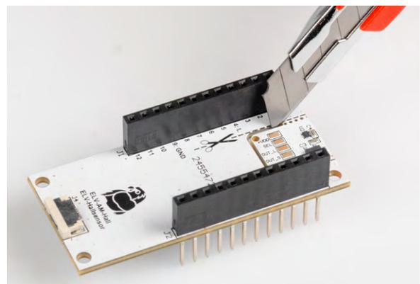
Bild 7: Wenn gewünscht, kann die Ausbrechplatine mit einem Cuttermesser oder Seitenschneider herausgetrennt werden.
