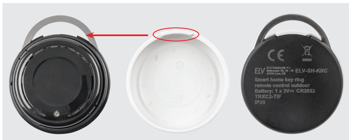
▲ Bild 6: So wird die Mittelkappe (Lichtleiter nach unten) aufgesetzt.
