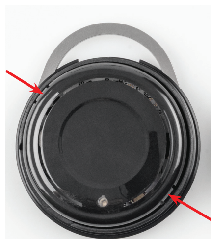
◀ Bild 25: Rasthaken leicht eindrücken
