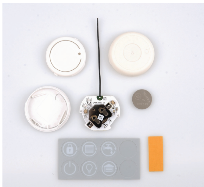
▲ Bild 2: Bausatz aus nur fünf Teilen – ganz ohne Löten; inkl. Aufkleber
