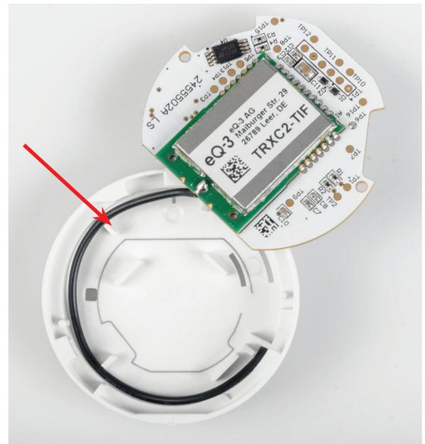
Bild 15: So wird die Antenne in das Gehäuseunterteil geklemmt.
