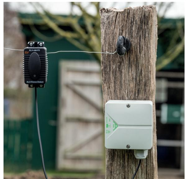
Bild 4: Fertig montierte Weidezaunüberwachung
