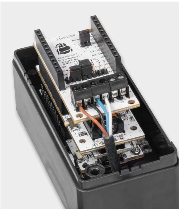
Bild 10: Am Interface angeschlossenes Sensorkabel des SoMo1
