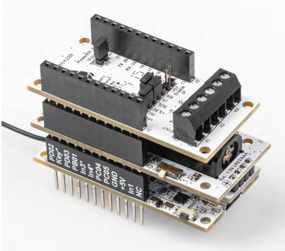
Bild 4: Stapel aus Base, Powermodul und Interface
