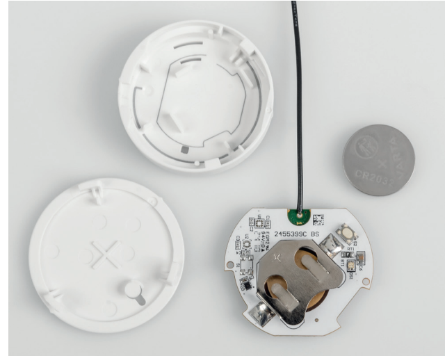
Bild 2: Bausatz aus nur vier Teilen – ganz ohne Löten!
