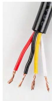
Bild 6: Abisolieren der Einzeladern nach dem Entfernen des Steckers vom Sensor
