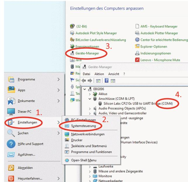
Danach ist über ein Terminalprogramm wie z. B. HTerm dieser COM-Port auszuwählen und eine Verbindung zum Interface aufzubauen. Über die Steuerbefehle des USB-I2C-2 kann dann eine Kommunikation mit den angeschlossenen I<sup>2</sup>C Bausteinen erfolgen.
