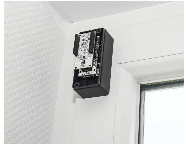
Bild 11: Das ELV Applikationsmodul Lagesensor lässt sich am besten in Verbindung mit dem modularen Gehäuse MHO101a anbringen.
