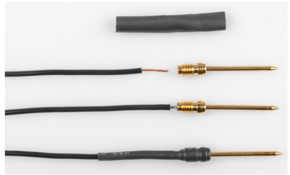
Bild 26: So wird das Prüfkabel angefertigt.
