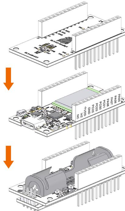
Das Basismodul wieder vom USB-Type-C-Kabel trennen und anschließend die Spannungsversorgung durch ein Powermodul des ELV-Modulsystems herstellen.
