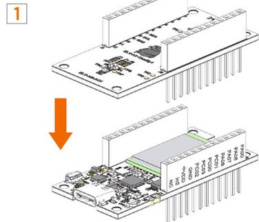
1 ELV-AM-A01 über die Stift-/Buchsenleisten mit einem Basismodul des ELV-Modulsystems verbinden.
