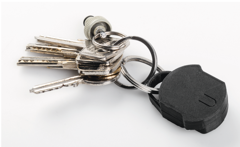
Bild 11: ELV-LW-MOB im 3D-Druck-Gehäuse als Schlüsselfernbedienung
