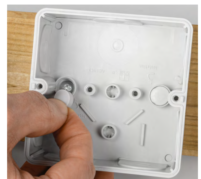
Bild 9: Einsetzen der Abdichtungen vor dem Einsetzen der Platine
