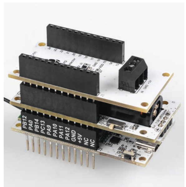
Bild 2: Anwendungsbeispiel für einen Modulstapel bestehend aus ELV-AM-FD (oben), dem ELV-PM-LR03 (Mitte) und der ELV-LW-Base (unten)
