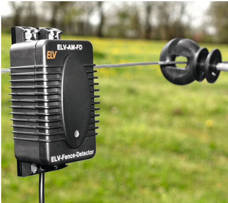
Bild 21: Nach dem Einstellen der Ansprechempfindlichkeit wird der Sensor verschlossen und fest montiert.
