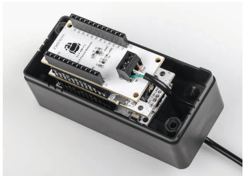
Bild 16: Anschluss des Kabels an das Applikationsmodul
