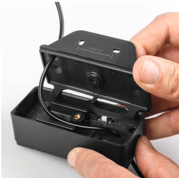
Bild 15: Einführen des Kabels in das ELV-Modulgehäuse
