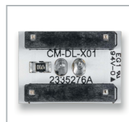
Bild 26. Der Vorwiderstand (470 \Omega ) ist bei der LED-Platine integriert.
