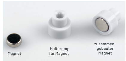
Bild 13: So wird der Testmagnet zusammengesetzt.
