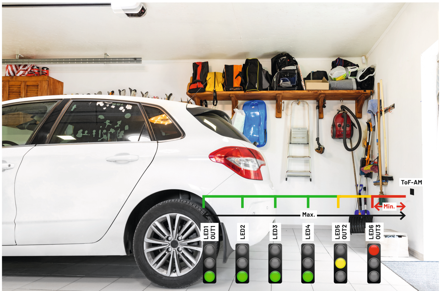
Anwendungsbeispiel als Abstandsmelder mit dem Verhalten der LEDs und der Relaischaltausgänge
