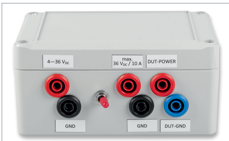
Bild 16: Die Anschlüsse der „Messbox“ auf der Rückseite
