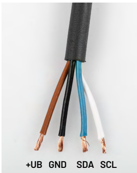
Bild 5: Die Funktionsbelegung der farbigen Sensoranschlüsse
