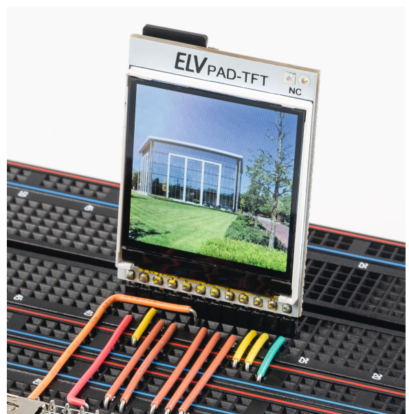
Bild 8: Für eine stehende Montage auf dem Breadboard können optional abgewinkelte Stiftleisten verwendet werden.
