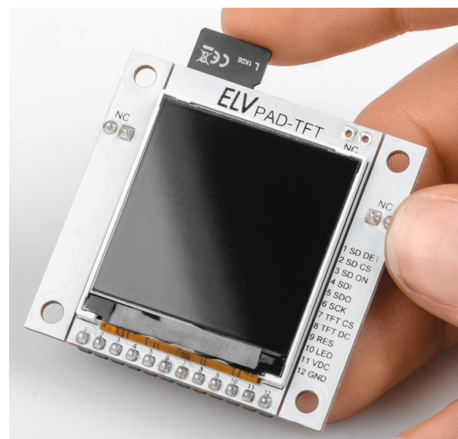
Bild 13: Das fertig aufgebaute PAD-TFT mit der eingeschobenen microSD-Karte.
