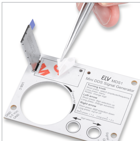
Bild 18: Die Schutzfolie des Doppelklebebands wird entfernt.
