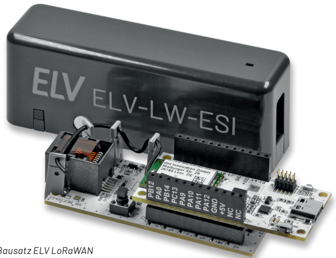
Bild 1: Bausatz ELV LoRaWAN Energiezähler Sensor Schnittstelle ELV-LW-ESI – im Gehäuse (hinten) und die Platine (Basiseinheit und aufgestecktes Funkmodul, vorne)
