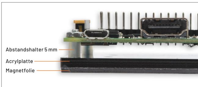
**Bild 1:** Seitliche Ansicht des montierten Moduladapters
