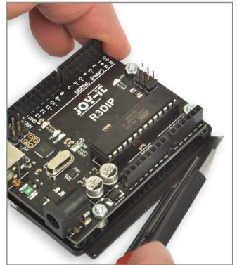
**Bild 3:** Überstehende Magnetfolie wird mit einem Cuttermesser abgeschnitten.
