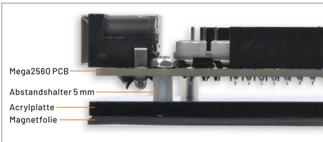
**Bild 1:** Seitliche Ansicht des montierten Modulträgers
