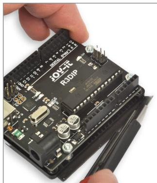
**Bild 3:** Überstehende Magnetfolie wird mit einem Cuttermesser abgeschnitten.
