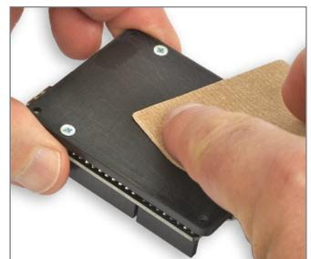
**Bild 2:** Die Oberfläche der Acrylplatte muss mit Schleifpapier aufgeraut werden.
