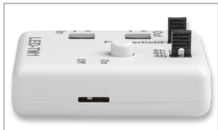
Bild 15: On-/Off-Schiebeschalter im Gehäuse
