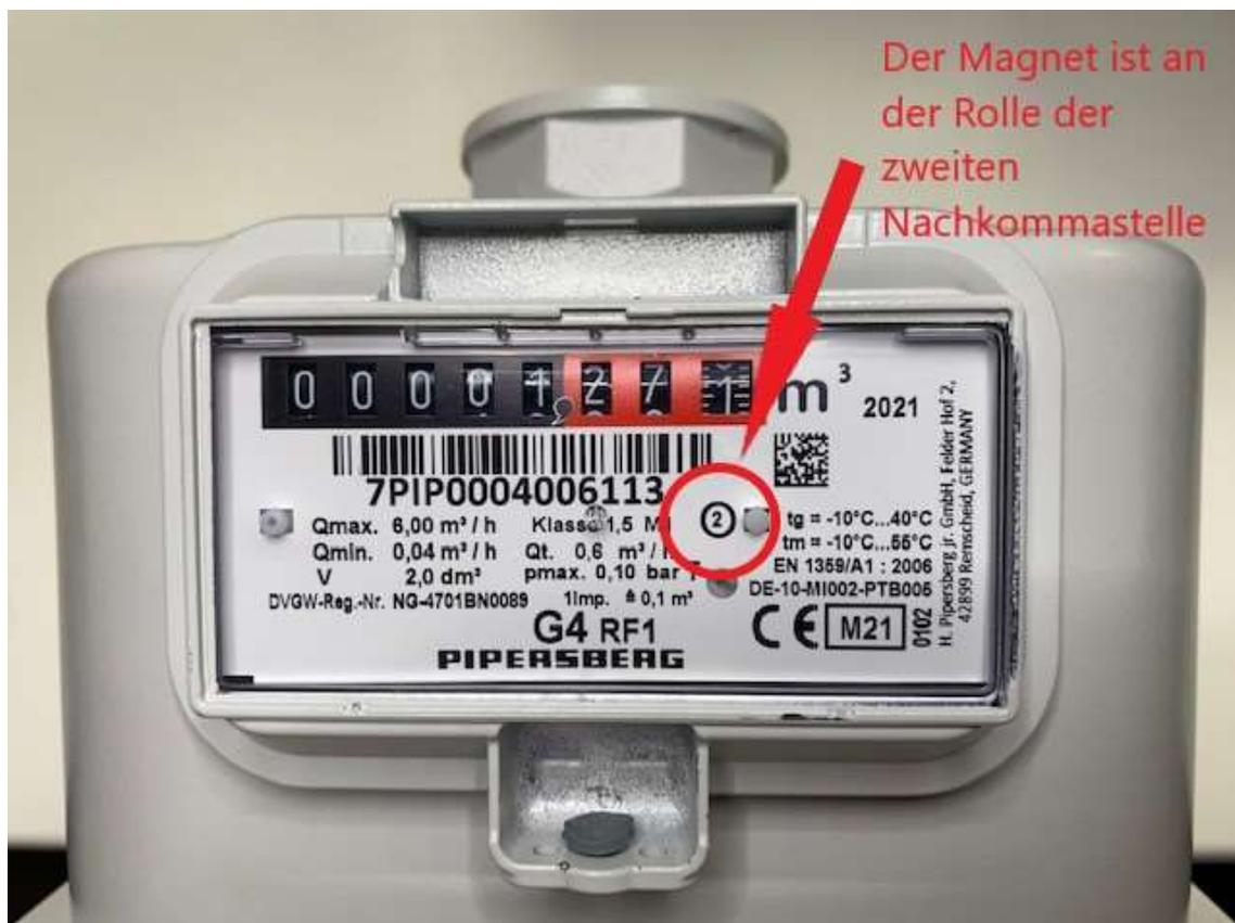
Der Magnet löst berührungslos den im ES-GAS-2 Sensor eingebauten Reedkontakt aus, der daraufhin einen Stromkreis schließt. Bei jeder Umdrehung wird ein Impuls ausgelöst.
