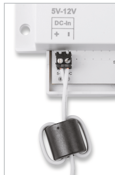
Bild 18: Der Ferritring in der Zuleitung verhindert die Beeinflussung durch Störsignale.
