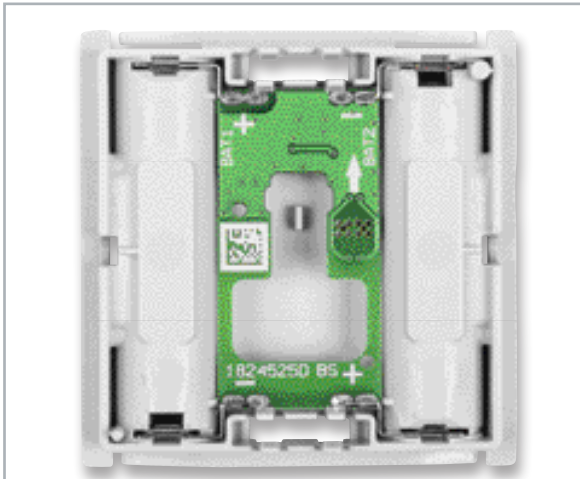
Bild 14: Die in das Gehäuse eingesetzte Batterieplatte
